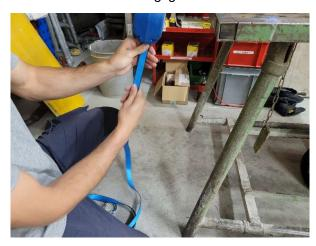
Nach der visuellen Kontrolle werden die Höhensicherungsgeräte aufgeschraubt und mittels Drehmomentschlüssel geprüft:
