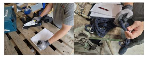
Neben der Kontrolle des Material-Zustandes wird das Herstellungsjahr überprüft. Sollte die Lebensdauer überschritten sein, dann muss das Material entsorgt und darf nicht weiter verwendet werden.
